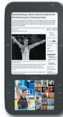
Портативный Alex eReader — на нижнем 3,5-дюймовом цветном дисплее пользователь может искать контент в Интернете и выводить его на основной дисплей
