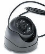
Компактная видеокамера для установки в салоне или кузове автомобиля. Предназначается для передачи фотографий (640×480 точек) в диспетчерский центр по событию, с определенной периодичностью или по запросу
