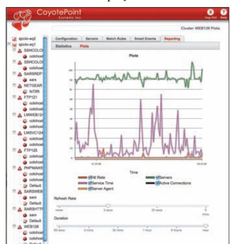
Интерфейс E650GX включает панель управления на базе технологии Ajax, сочетающую средства конфигурирования и статистическую информацию
