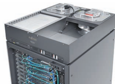
В Fujitsu Primergy CX1000 S1 охлаждение вычислительных узлов обеспечивают два мощных вентилятора, установленные в верхней части стойки
