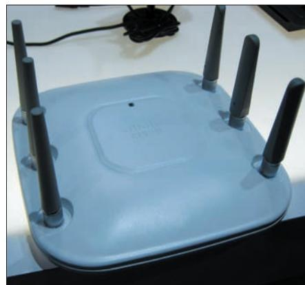
Устройство Aironet 3502e со встроенной технологией CleanAir стоит 1495 долл. Оно имеет внешние коннекторы для антенн и поддерживает двухдиапазонный протокол 802.11n
