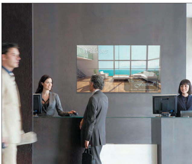
Новые модели LED UD55A/UE55A предназначены для использования в составе видеостен — толщина стыка всего 5,8 мм (UD55A) и 10,4 мм (UE55A)
