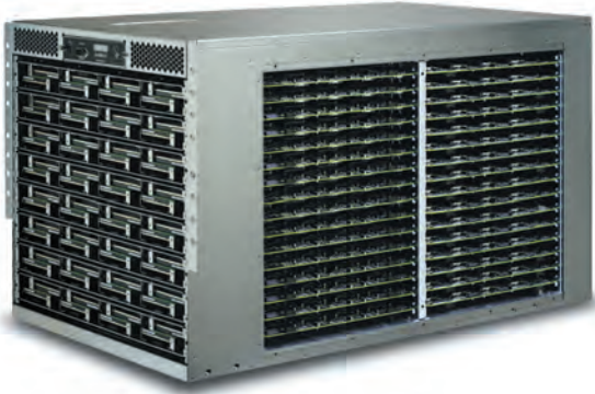
Сервер SeaMicro SM10000-64HD включает до 384 двухъядерных процессоров Intel Atom
