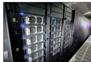
Созданный IBM суперкомпьютер Roadrunner, установленный в Национальной лаборатории в Лос-Аламосе, представляет собой кластер из систем BladeCenter, использующих процессоры IBM PowerPC Cell с частотой 3,2 ГГц и двухъядерные процессоры AMD Opteron. Его производительность объявлена на уровне 1,04 Пфлопс
