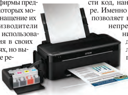
Главная особенность Epson L100 — встроенный контейнер с резервуарами для чернил
