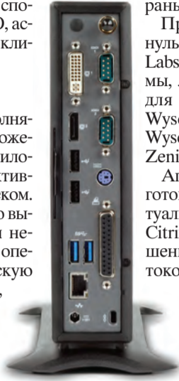
Семейство тонких клиентов Wyse Z90 поддерживает унаследованные интерфейсы, удлиняя цикл жизни приложений, изначально не рассчитанных на работу в виртуализированной среде
