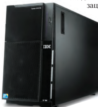
С помощью специального монтажного комплекта башенный x3500 M4 превращается в стоечный пятиюнитовый сервер
