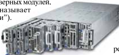
В шасси PowerEdge C8000 можно комбинировать разные типы “салазков”
