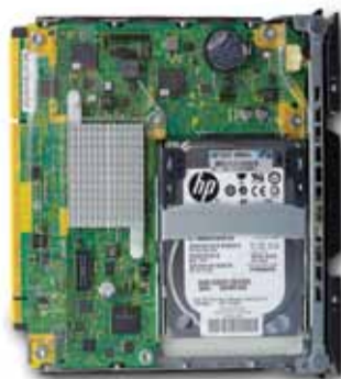
Сервер-картридж HP ProLiant Moonshot на базе процессора Intel Atom S12000
