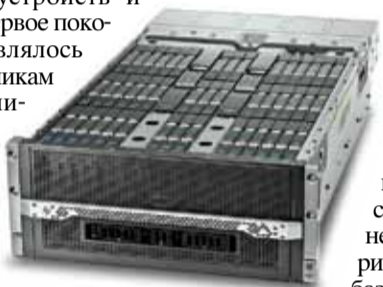
Шасси HP Moonshot 1500 вмещает 45 устанавливаемых вертикально серверов-картриджей
