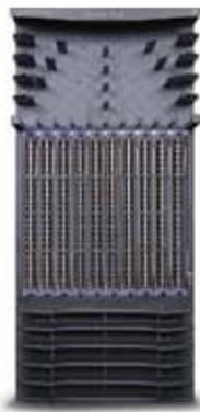
Шассийный коммутатор HP FlexFabric 12900 поддерживает до 768 десятигигабитных портов либо 256 сорокагигабитных
