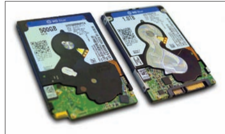
Теперь в ассортименте 2,5-дюймовых накопителей WD есть модели толщиной не только 7, но и 5 мм
