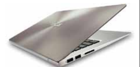
Усиленное шасси и крышка из цельного листа металла гарантируют отсутствие скрипов при открывании устройства
