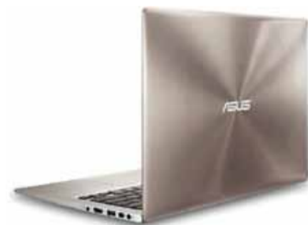
Все три порта USB модели UX303LN соответствуют стандарту SuperSpeed USB 3.0 со скоростью обмена данными до 5 Гбит/с
