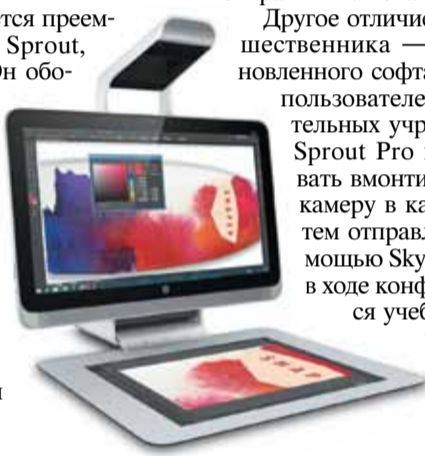
Sprout Pro дополнен специальным модулем, в котором расположились проектор и камеры для сканирования объектов, а также дополнительная сенсорная панель, на которую проецируется изображение
