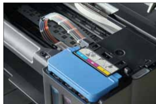
Сравнительно короткие патрубки и высокое расположение контейнеров с чернилами обеспечивают Canon PIXMA G3400 возможность непрерывной высококачественной печати значительных объемов документов
