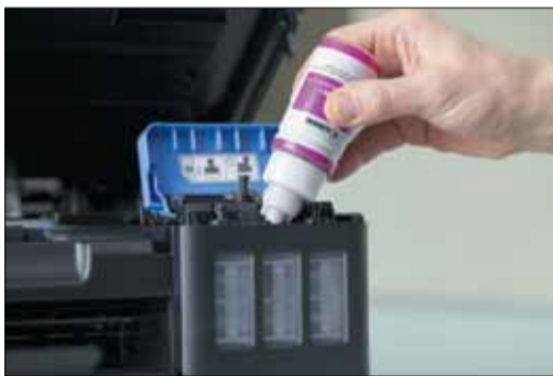
Заправка СНПЧ фирменными чернилами производится быстро и аккуратно благодаря продуманной конструкции крышек контейнеров и бутылочек с тономом
