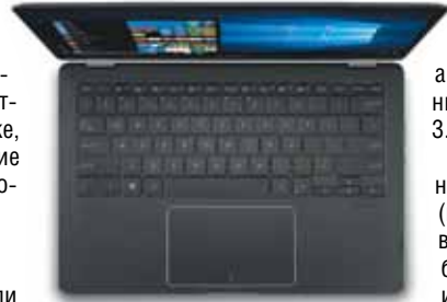
Глубина хода клавиш ASUS ZenBook Flip S составляет 1,0 мм, а высокоточная мультисенсорная панель поддерживает развёрнутую систему жестового ввода ASUS Smart Gesture
