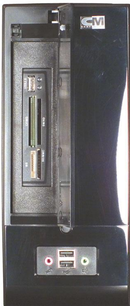
CM PROFI M70P - вид спереди с открытой крышкой отсека карт-ридера
