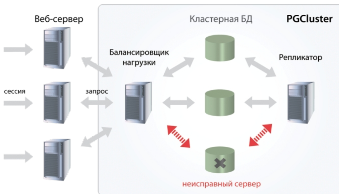
Рис. 7 Кластер с функцией балансировки нагрузки
